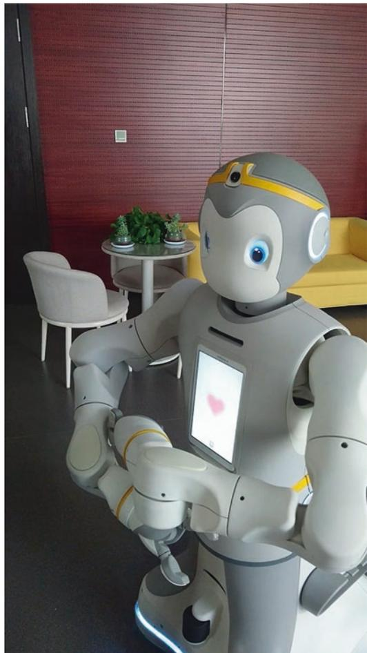
mit zwei Armen gleichzeitig arbeiten, hat ein integriertes Tablet zur Darstellung seines Zustandes sowie Mikrofon und Lautsprecher für die verbale Kommunikation.
